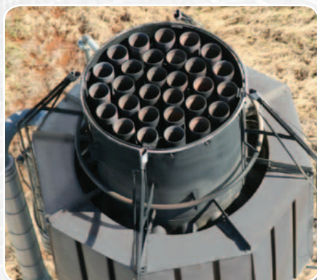
Факельный оголовок HCL с подачей пара
